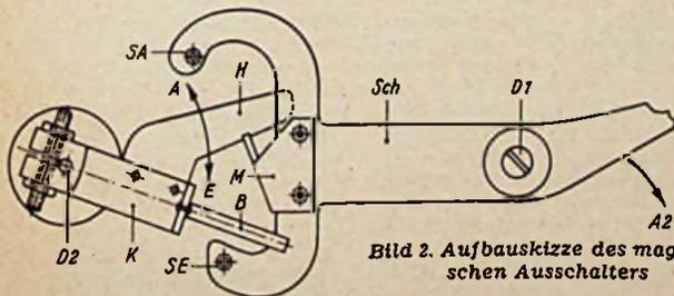
Bild 2. Aufbauskitze des magnetischen Ausschalters
