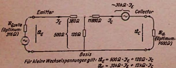
Bild 1. Vereinfachtes Ersatzschaltbild des SAF-Transistors VS 200
