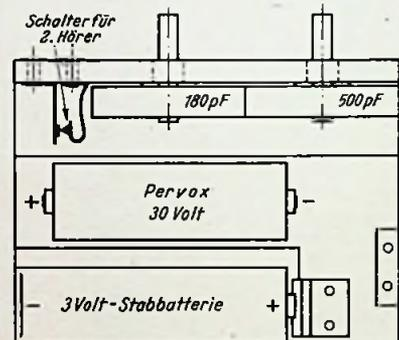
Bild 13. Einzelteilanordnung von der Batterieseite gesehen
