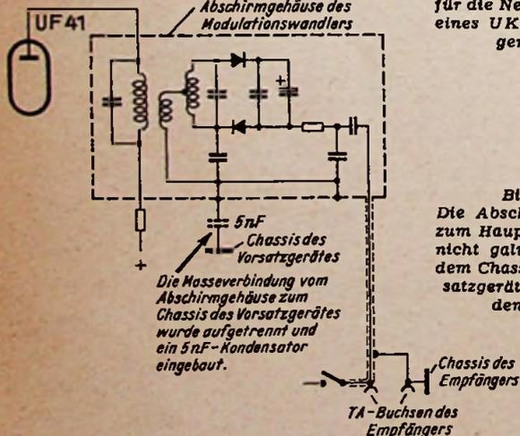
Bild 2. Die Abschirmleitung zum Hauptgerät darf nicht galvanisch mit dem Chassis des Vorsatzgerätes verbunden sein
