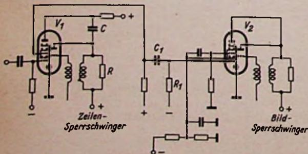
Bild 160. Philips-Schaltung für Amplitudensieb, Trennstufen und Kippgeneratoren
