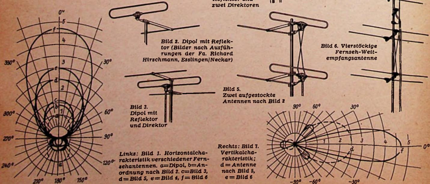
Links: Bild 1. Horizontalcharakteristik verschiedener Fernsehantennen. a=Dipol, b=Anordnung nach Bild 2, c=Bild 3, d= Bild 5, e= Bild 4, f= Bild 6
