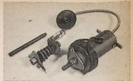
Bild 6. Vollständiger Horizontalübertrager entsprechend der neuen Schaltung. Die Zusatzspule ist auf ein Hartpapierrohr gewickelt und wird von der Heizwicklung für die Hochspannungsgleichrichterröhre umgeben. Im Innern befindet sich die links daneben abgebildete Hochspannungsspule mit der Hochspannungsgleichrichterröhre. Der verschiebbare Ferritstab gestattet eine Veränderung der Bildbreite
