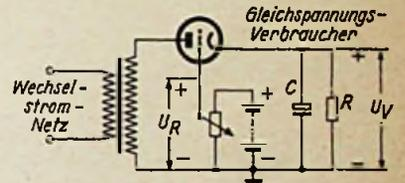
Bild 1. Prinzipschaltung eines Netzspannungs-Gleichrichters mit regelbarer Ausgangsspannung
