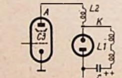
Bild 3. Neue, einfache Schaltung einer Zeilenendstufe
