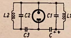
Bild 4. Prinzipschaltung von Bild 3 bei nichtstromführender Endröhre
