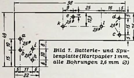
Bild 7. Batterie- und Spulenplatte (Hartpapier 1 mm, alle Bohrungen 2,6 mm Ø)
