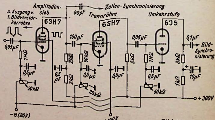
Bild 161. Versuchsschaltung mit Amplitudensieb, Trennröhre und Umkehrstufe
