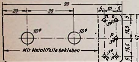
Bild 5. Frontplatte (Sperrholz 6 mm); n, o für Anschluß des 1. Hörers; p für Antennenanschluß; q, r für Anschluß des 2. Hörers, Lochdurchmesser = 3 mm
