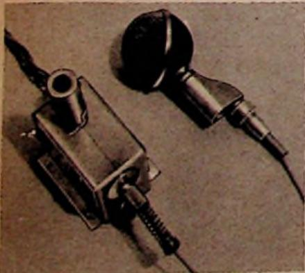
Bild 3. Gesamtansicht des einbaufertigen Vorverstärkers mit Amateurmikrofon
