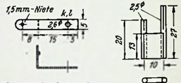
Bild 9. Klemmfeder für die Anodenbatterie (Messingblech 0,3 mm, federhart)
