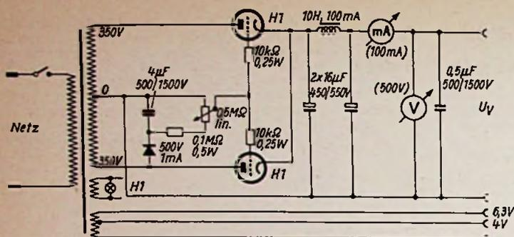
Bild 2. Vollständiges Schaltbild eines Zweiweg-Gleichrichters mit elektronischer Regelung der Ausgangsspannung
