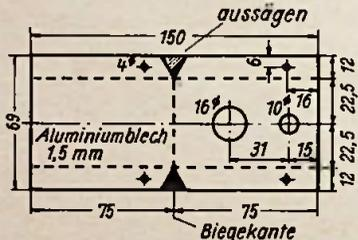
Bild 5. Maßskizze für das Chassis
