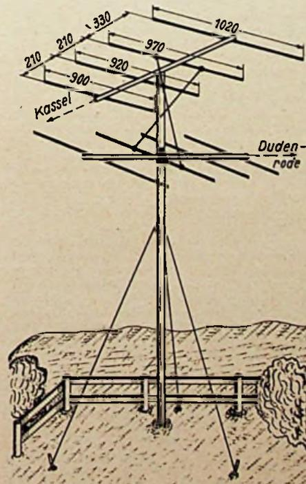
Bild 2. Aufbau der 2-m-Umlenkanlage. Die Speiseleitungs-Anschlußpunkte sind 20 cm von der Strahlermitte entfernt. Die Maße der unteren Dipolgruppe entsprechen denen der oberen, jedoch liegt im Bild der Reflektor links
