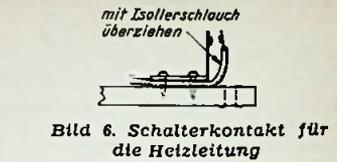
Bild 6. Schalterkontakt für die Heizleitung
