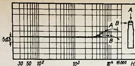
Bild 2. Frequenzkurve des Kleinmikrofon M 200
