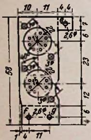
Bild 11. Trägerblech für Röhrenfassungen (Aluminiumblech 0,5 mm)
