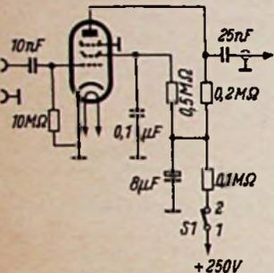
Bild 1. Schaltung des kleinen Mikrofon-Vorverstärkers mit der EF 94
