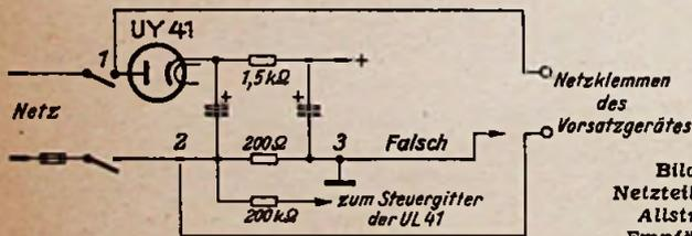
Bild 1. Netzteil eines Allstrom-Empfängers mit Anschlußpunkten für die Netzklemmen eines UKW-Vorsatzgerätes
