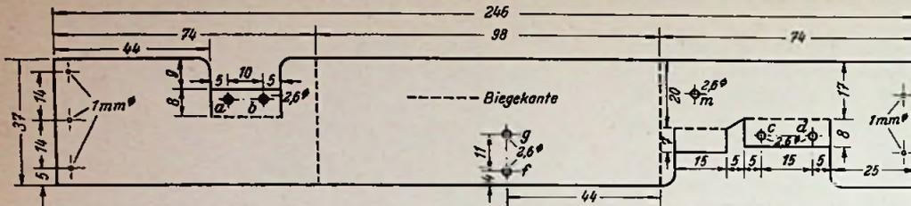
Bild 4. Chassisblech (Aluminiumblech 0,5 mm). Löcher ohne Maßangabe = 2,5 mm Ø
