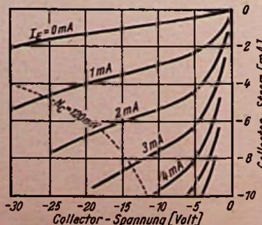
Bild 2. Collector-Kennlinien
