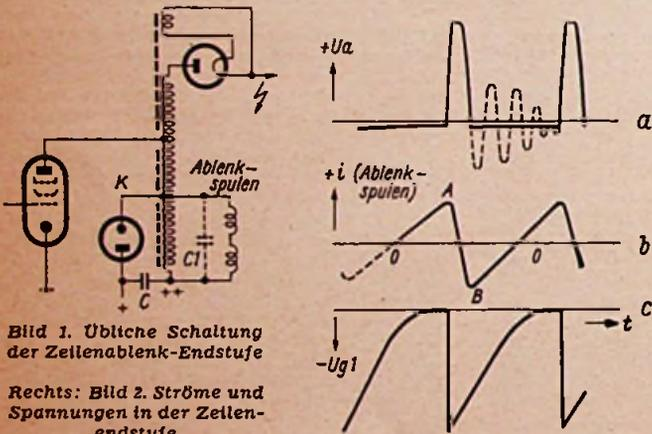
Bild 1. Übliche Schaltung der Zeilenablenk-Endstufe
